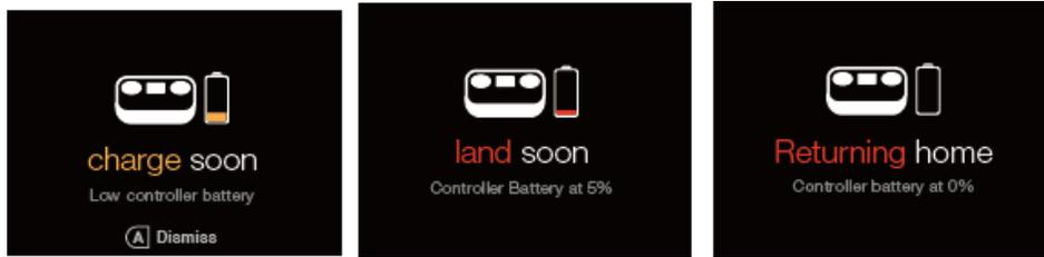
図 7.2.6.1 : コントローラー – コントローラーバッテリーの警告
