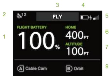
図 5.5.1：コントローラー - 飛行中のデータ
