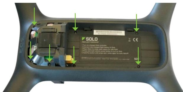
図 10.5.2.1 : バッテリートレーの分解
