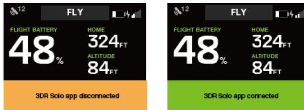
図 7.2.2.1 : コントローラー – アプリの通信接続の警告
