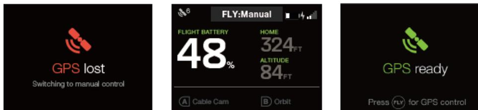
図 7.2.4.1 : コントローラー - GPS 信号の警告
