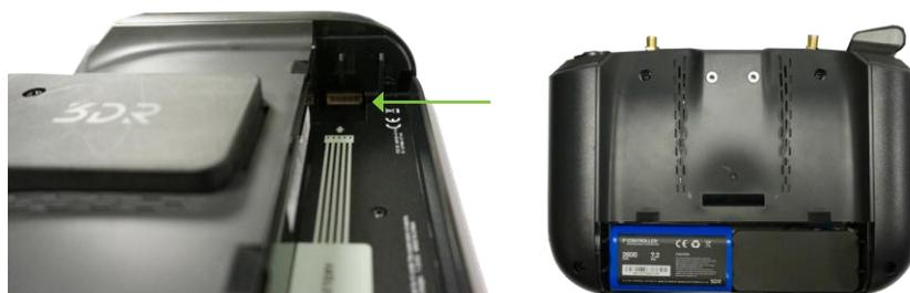
図 10.1.1 : コントローラーバッテリーの取り付け
