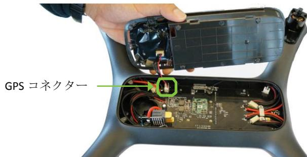
図 10.5.2.2 : バッテリートレーの取り外し
