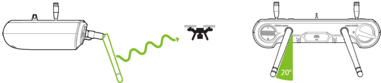
図 4.12.1 : コントローラー アンテナの方向
